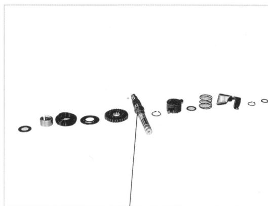
механизм привода стартера в разобранном виде
