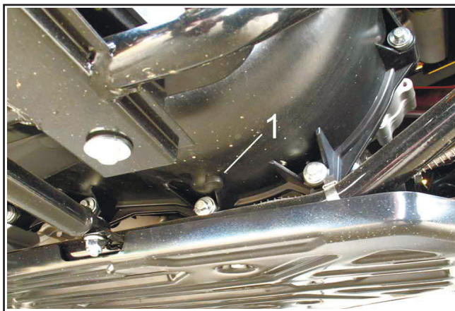
1. Сливная пробка кожуха приводного ремня.
