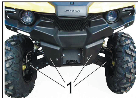
1. Пыльники передней оси (по 2шт. на каждую сторону).
