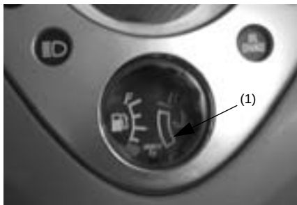
(1) Medidor de las temperatura del fluido refrigerador
