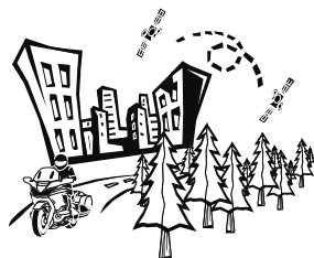
Niedrige GPS-Satelliten-Position (unter 10 Grad) am Horizont.
