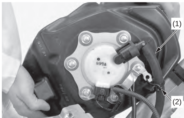
(1) tubo flessibile di alimentazione (2) morsetto
