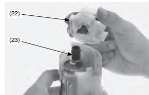
(22) ogranicznik pompy paliwa (23) gumowy element tłumiący
