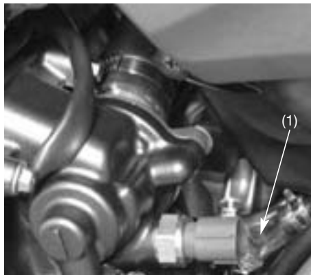
(1) Tubo de drenaje
