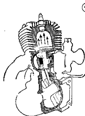
Abb. 5. Arbeitsschema des DKW-Zweitaktmotors mit Umkehrspülung.
