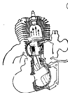
Abb. 5. Arbeitsschema des DKW-Zweitaktmotors mit Umkehrspülung.
